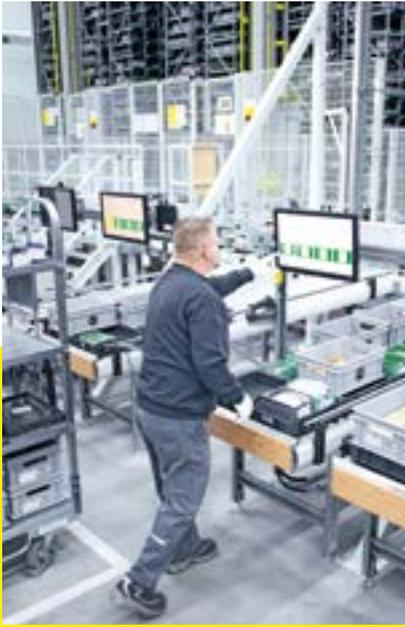
Les bacs préparés sont répartis sur les voies de tri dans la séquence de prélèvement correcte selon des objectifs de production et d'assemblage.
