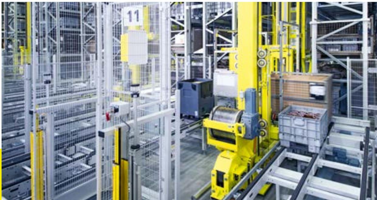
Le magasin à grande hauteur est desservi par cinq transstockeurs du type *maxloader* chacun équipé d'un préhenseur approprié au stockage à double profondeur.
