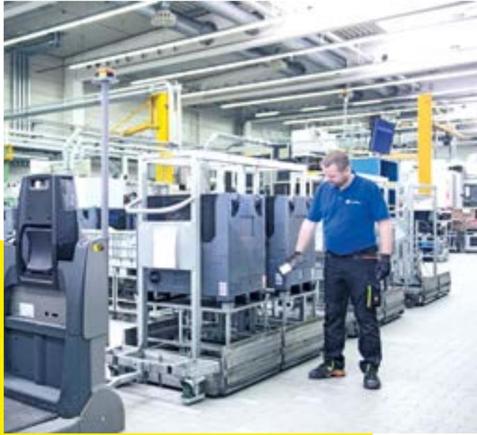
Les trains de livraison sont contrôlés par un système spécialement développé par psb pour MR et intégré dans le WMS *selektron*.
